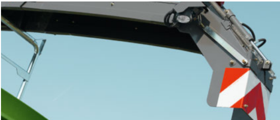
Kraftige LED-arbejdslygter på udkasteren kan fås som ekstraudstyr.
