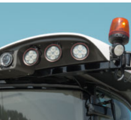
3 par arbejdslygter på taget, kørelygter foran på taget, sidelys og rotorblink.
