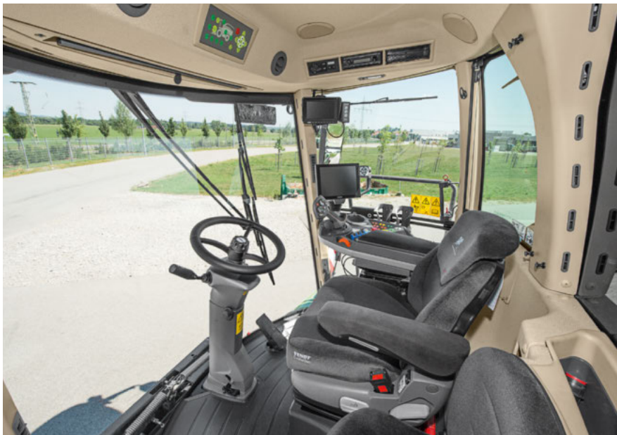
Visio5-kabinen er udviklet til optimalt udsyn med perfekt ergonomi og brugervenlige betjeningsfunktioner. Takket være tagets særlige form har føreren altid udsyn til tuden. Automatisk klimastyring og varme sikrer et behageligt arbejdsmiljø.
