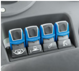
Funktioner som åbning/lukning af majsskærebordet og pickuppens støttehjul, vipning af skærebordet, løft/sænkning af tømmetuden styres praktisk med vippekontakterne.
