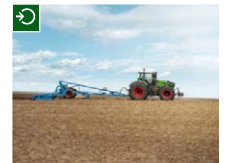
Takket være TMS (Tractor Management System) og automatisk spidsbelastningsregulering 2.0, tilpasser traktoren motorens hastighed optimalt i forhold til kørehastigheden.
