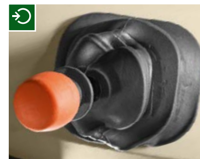
Håndbremseassistent i automatisk stilling: Håndbremsen aktiveres automatisk.
