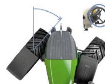
Med VarioActive kan du komme igennem den fulde styrevinkel med blot én drejning af rattet.
