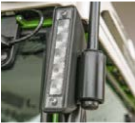
□ Blinklys- og positionslys er praktisk integreret i A-stolpen.
