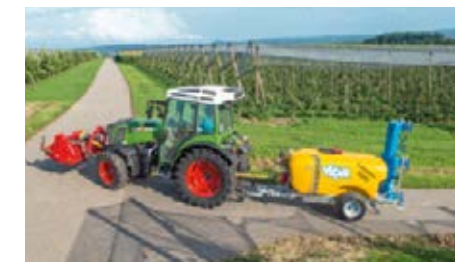
Effektiv kombination af processer. Med 540E/750 front-PTO kan du køre med ukrudtsharven i arbejdhastighed, selv om sprøjten bagpå og traktoren arbejder med reducerede motoromdrejninger.
