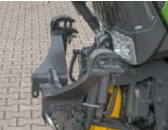
De forreste hydrauliske liftarme kan foldes op i få trin.
