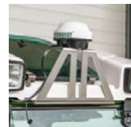
Positionsbaseret GPS-styresystem giver en nøjagtighed ned til 2 cm i Fendt 200 V/F/P Vario.
