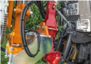
Monteringspladerne, integreret i frontliften, giver altid en stabil og sikker base for tunge, frontmonterede redskaber.
