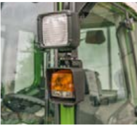
□ Integrerede arbejdslygter i A-stolpen giver ekstra belysning af omgivelserne og beskytter dine afgrøder
