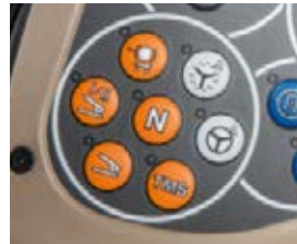
Det forstærkede styresystem VarioActive og Guidance-system kan praktisk aktiveres på ratkonsollen.
