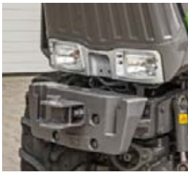
□ Uden frontlift er der mulighed for at montere ekstra ballast direkte på rammen.
