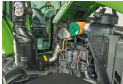
Luftfilteret på Fendt 500 Vario har en lang levetid takket være et forfilter og er let at tilgå ved vedligeholdelsesarbejde.
