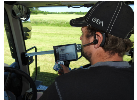
Med ISOBUS er kontrol og styring af TIGO ført op i traktorens joystick og på terminalen.
